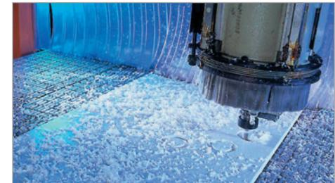
Fresado CNC de una plancha de plástico
