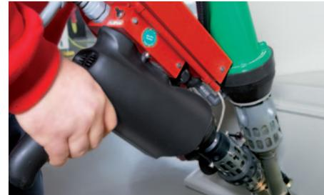
Un equipo de soldadura por extrusión.
