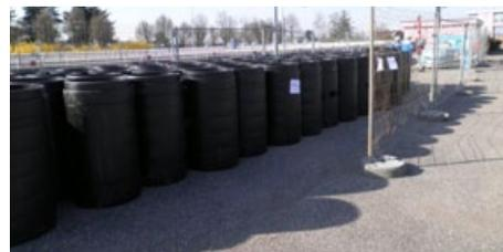
Módulos de tuberías cortas con diámetro exterior de 630 x 37,4 mm antes de su aplicación en la obra
