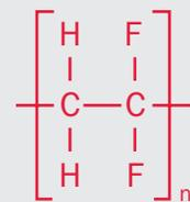
Fig. 2: Plástico parcialmente fluorado, p. ej. PVDF (fluoruro de polivinilideno)
