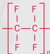
Fig. 3: Plástico totalmente fluorado, p. ej. PTFE (politetrafluoroetileno)
