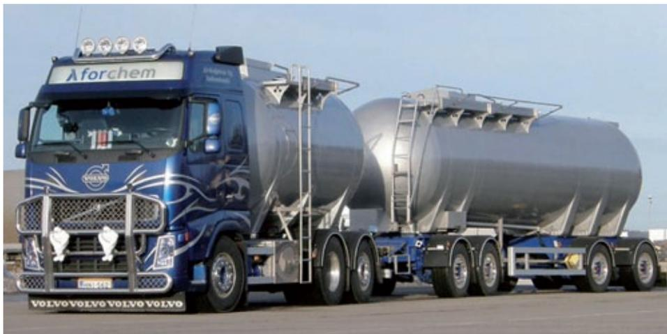
Depósitos para transporte por carretera de 18 o 31 m<sup>3</sup> de 2,3 mm SIMONA® E-CTFE-AK en estructura de doble laminado
