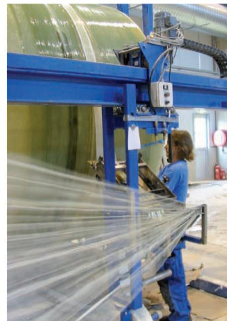
Aplicación de la estructura de plástico reforzado con fibra de vidrio mediante bobinado de filamentos en el material de liner que hay debajo, E-CTFE-AK de SIMONA®
