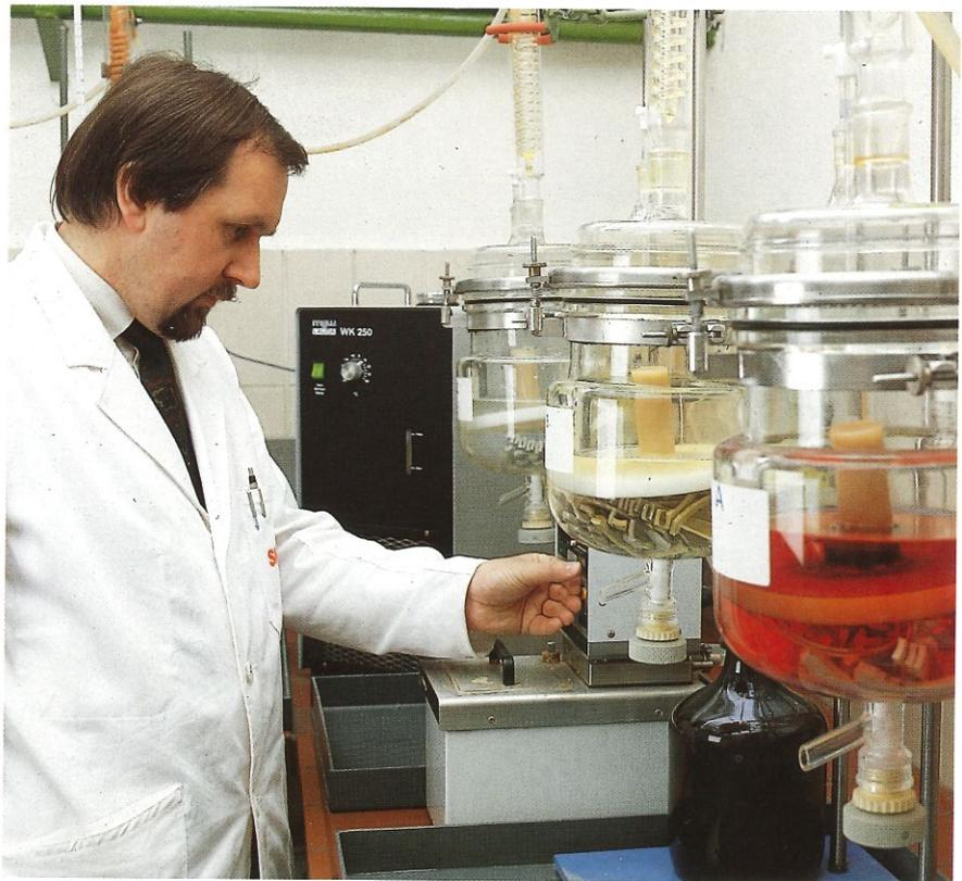
Überprüfung der chemischen Widerstandsfähigkeit im Immersionsversuch
