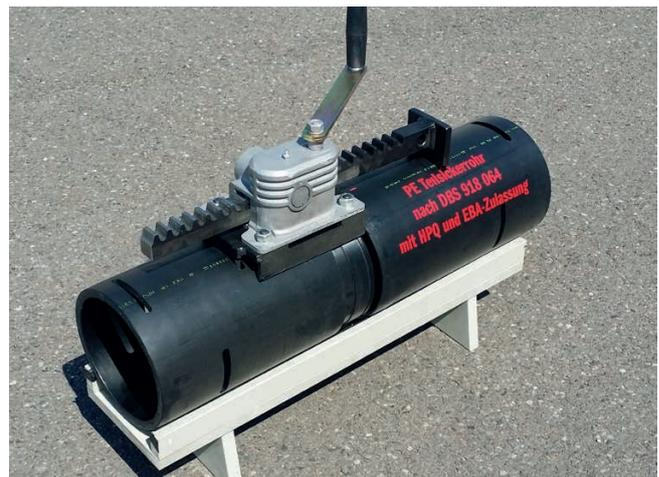
Einsatzbereite manuelle Einziehhilfe
