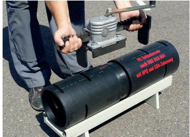
Einsetzen der manuellen Einziehhilfe
