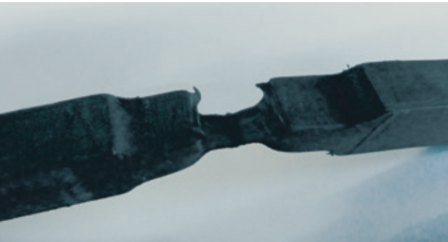
Probekörper nach Zeitstandbruch in der Schweißebene
