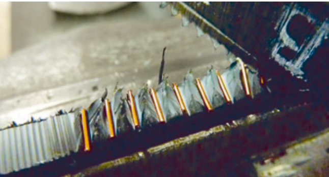
Bruchbild einer SIMOFUSE® Schweißprobe im Torsionsscherversuch
