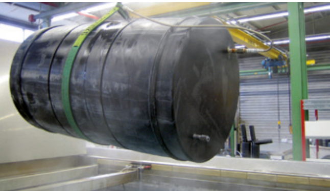
Prüfling PE 100, d 710 mm, SDR 17 aus der SIMONA eigenen Zeitstandanlage
