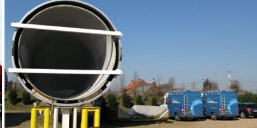
de g. à dr. : Vue dans les tubes inférieurs avec l'admission du gaz, transport des tubes composites en SIMONA® E-CTFE-GK/plastique renforcé fibre de verre, la construction SIMONA® E-CTFE-GK/plastique renforcé fibre de verre/acier prête pour le transport
