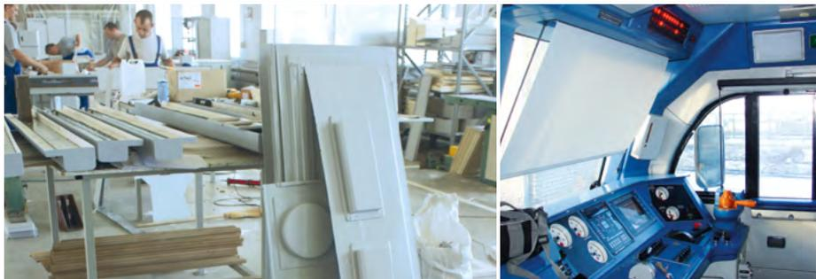
Oben: mit SIMONA® PVC-CAW-FR ausgekleideter Passagierwaggon; unten links: Fertigung der Verkleidungen; unten rechts: Wandelemente und Armaturenbrett im Führerstand
