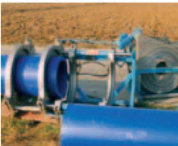
Rohrschweißmaschine mit PE 100 Trinkwasserrohr  $d = 500 \times 45,5$  mm.
