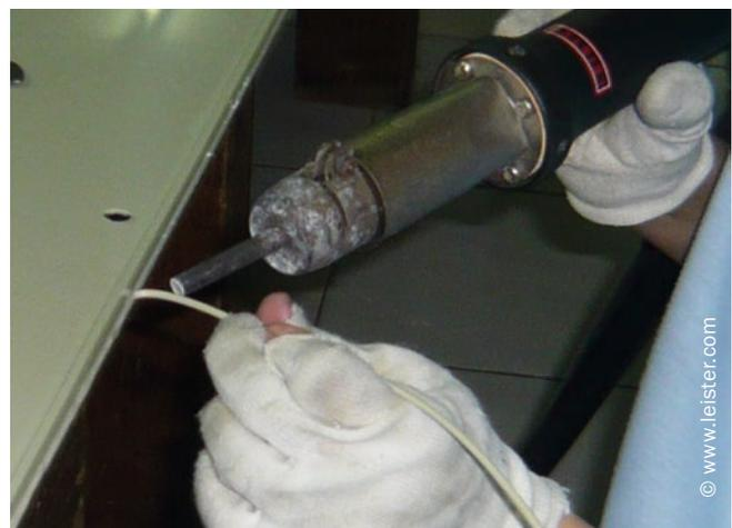
Abbildung 4: Warmgasfächelschweißen mit Rundscheidraht
