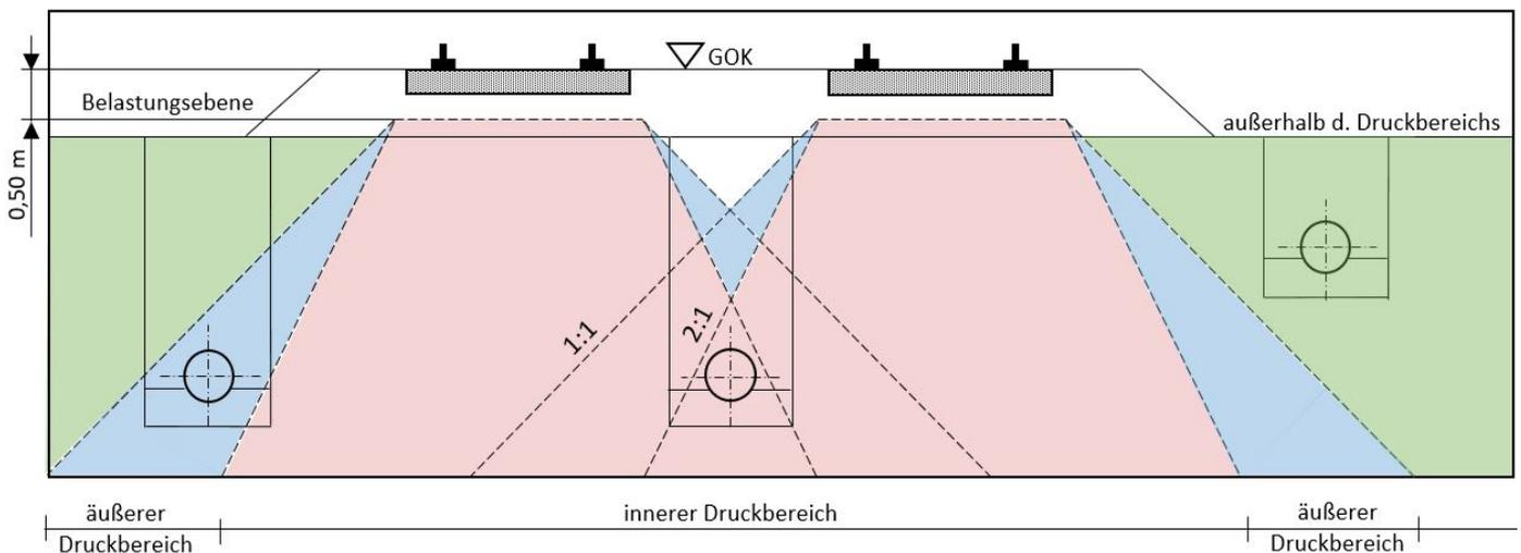
Rohrposition:  innerer Druckbereich     äußerer Druckbereich     außerhalb des Druckbereichs
