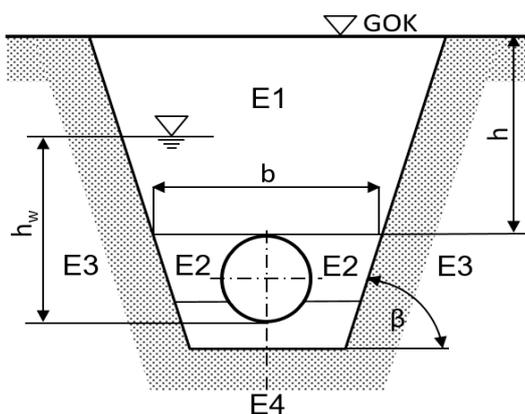
Grabenbreite in Rohrscheitelhöhe b: \_\_\_\_\_ [mm]
